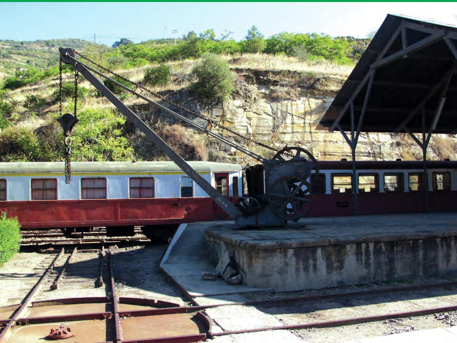
A placa giratória para virar as máquinas e o guindaste para cargas e descargas, observando-se em último plano uma carruagem de via estreita abandonada
