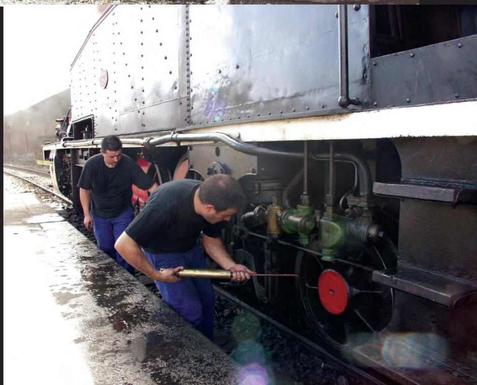
A preparação de uma locomotiva resulta ser muito mais complexa e apaixonante do que dar à chave de ignição de um motor de combustão. O aquecimento demora várias horas, sempre vigiado através dos vários manómetros de pressão. Todas as engrenagens estão constantemente a ser lubrificadas, promenor a ter em conta mesmo durante as paragens existentes no percurso.
